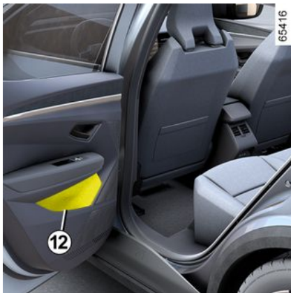
Compartimente de depozitare uși spate 12
